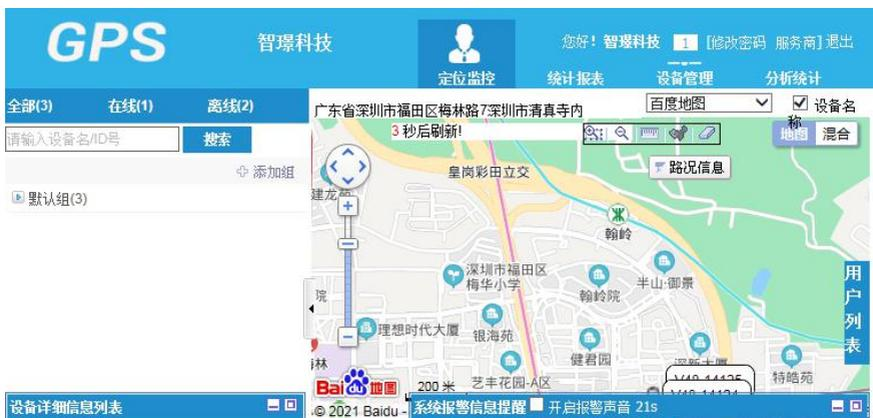
其中“系统报警信息提醒”列表，实时显示所有设备的报警信息；还可连接外放设备，勾选“开启报警声音”，循环播报报警信息。
